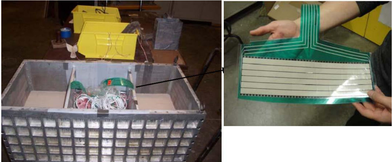
Σχήμα 5: Προετοιμασία μοντέλου. (α) Το υλικό επίχωσης τοποθετείται πίσω από τους τοίχους. (β) Οι επαφές των αισθητήρων πίεσης αφής έχουν ήδη τοποθετηθεί στους τοίχους.
