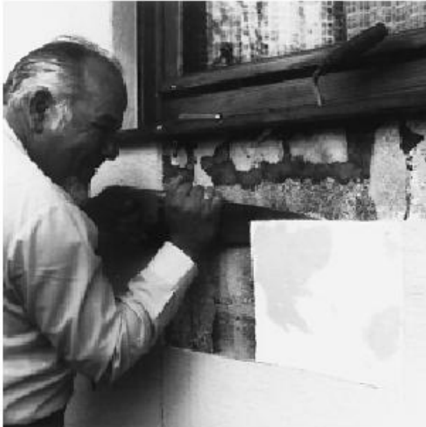
Σχέδιο 3: Παίρνοντας ένα δείγμα Styropor από ένα υπαίθριο σύνθετο μονωτικό σύστημα που αποτελείται από Styropor και ύφασμα-ενισχυμένο .
